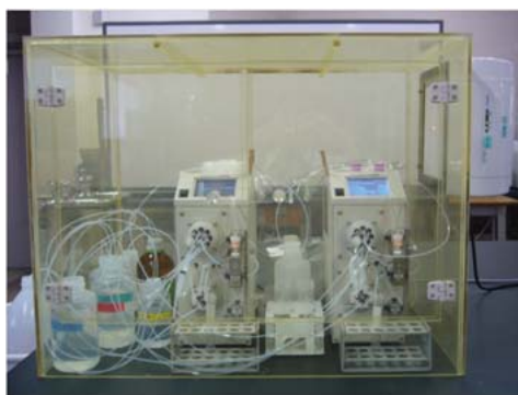
図2 自動固相抽出装置による海水試料の前処理
