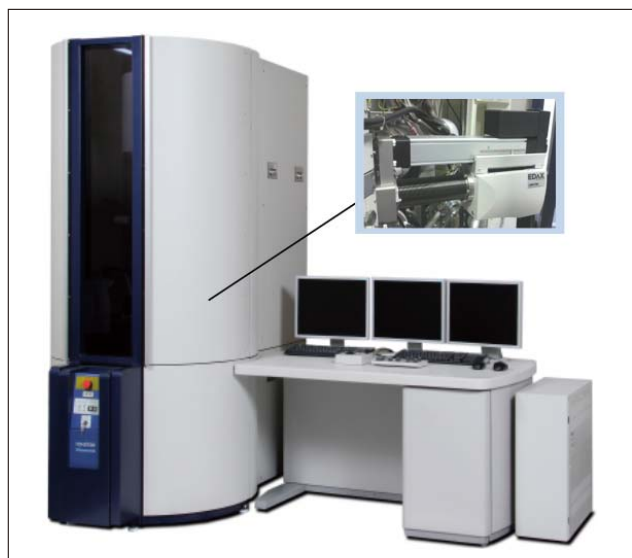
図1 大立体角EDX検出器と日立ハイテク製の自動収差補正機能を搭載した走査透過型電子顕微鏡HD-2700の外観
