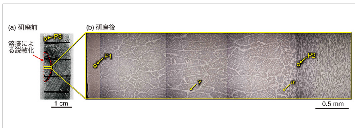
図 2 実験に用いた二相ステンレス試料の光学顕微鏡像 7)
