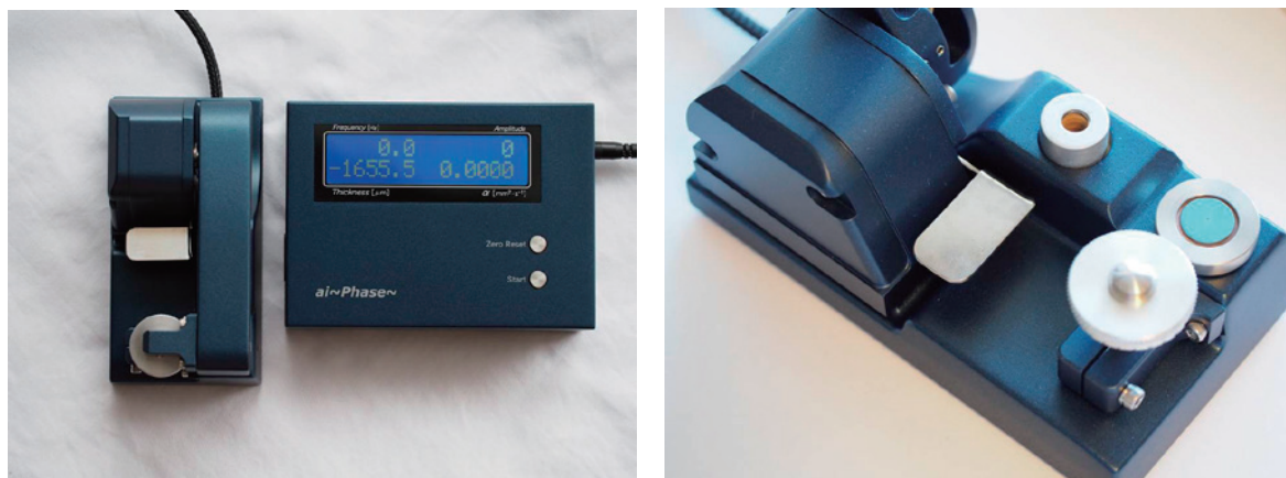
図1 アイフェイズ・モバイル（薄膜・熱拡散率測定型）
