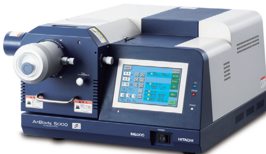
図1 イオンミリング装置 ArBlade 5000 の外観
