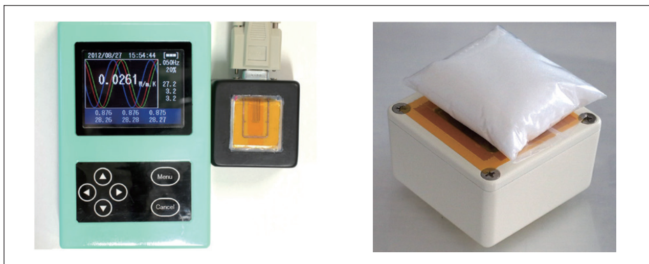
図6 アイフェイズ・モバイル(バルク材・熱伝導率測定型)装置全体と袋入り粉体の測定状況
