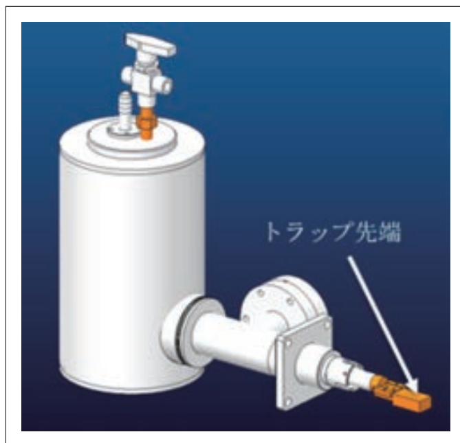
図2 アンチコンタミネーショントラップのCAD図 スラッシュ化窒素を用いることにより -200^{\circ}\text{C} まで冷却することに成功した。トラップ先端部は試料ホルダーの先端部 (試料部分) を包み込むように設計されている。
