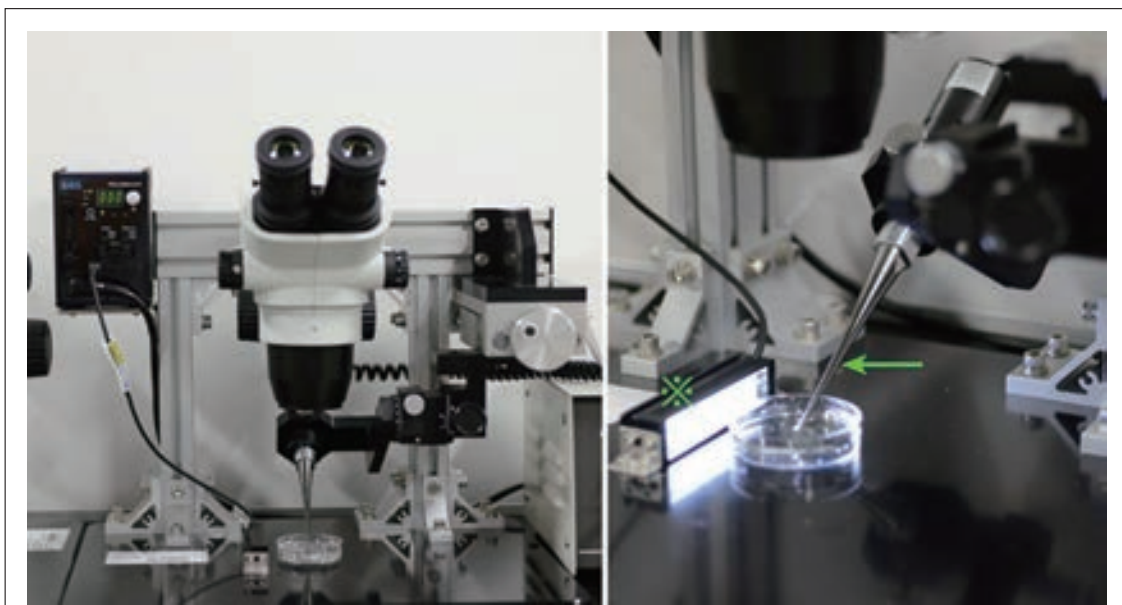
図3 試作した細胞膜剥離装置の正面写真（左）と斜めからの近景写真（右）：低出力プローブ型超音波発生装置，プローブのポジションコントローラー，実体顕微鏡，水平照明装置から構成されている。矢印は超音波発生用プローブ，アステリスク（※印）は水平照明装置
