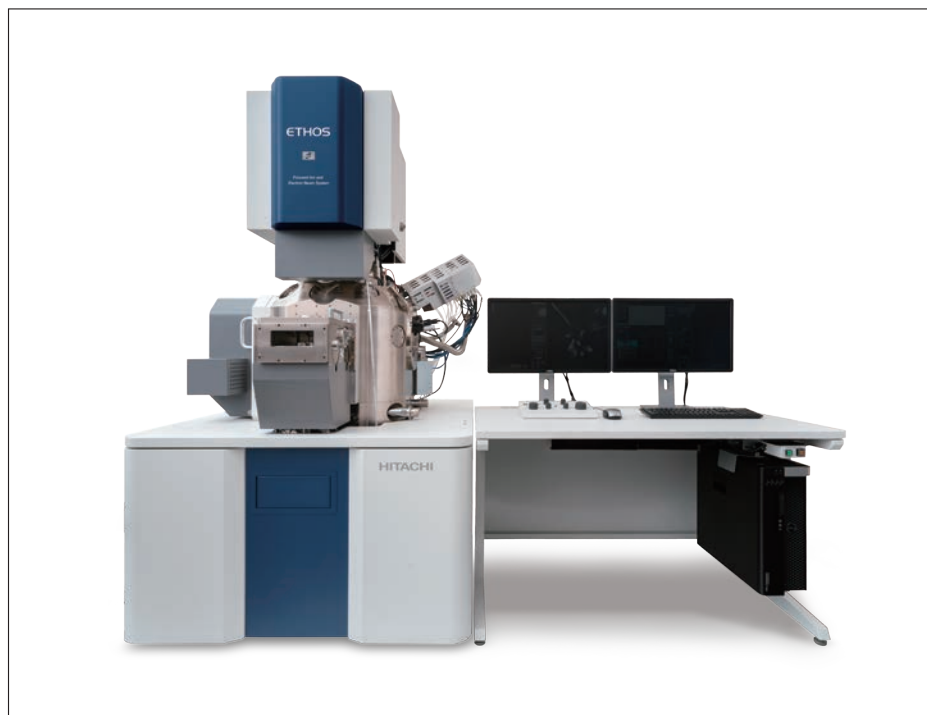
図1 高性能FIB-SEM複合装置「Ethos NX5000」
