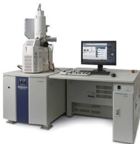
図1 SU5000走査電子顕微鏡外観と同装置仕様に合わせたGatan社製Murao加熱ステージの外観
