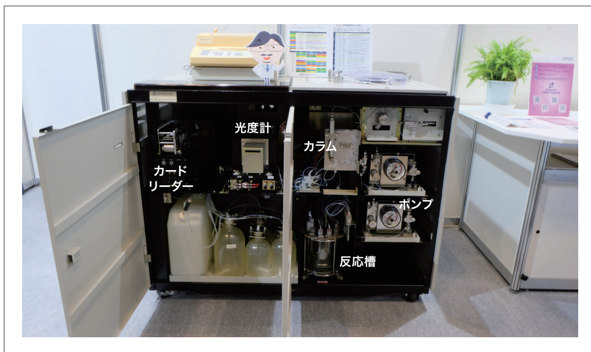
図6 835形の内部構造
