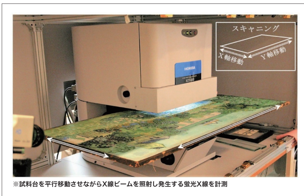
図4 ゴッホ「ドービニーの庭」のX線分析顕微鏡によるスキャンニング蛍光X線測定
