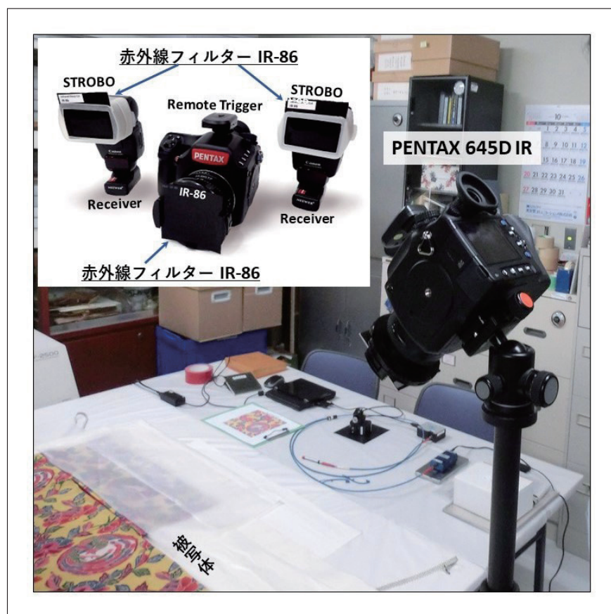
図1 赤外線写真撮影装置
