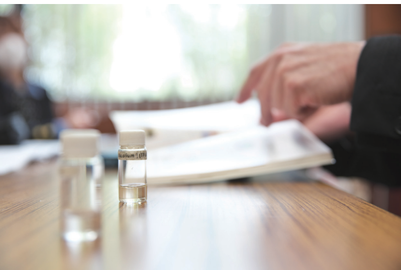
常温で液体として存在するイオン液体。陽イオンと陰イオンが結合した化合物であり、陽イオンと陰イオンが電氣的に引き合っている。そのため、水などとは異なり、熱を加えても、真空中に入れても決して蒸発することがない
