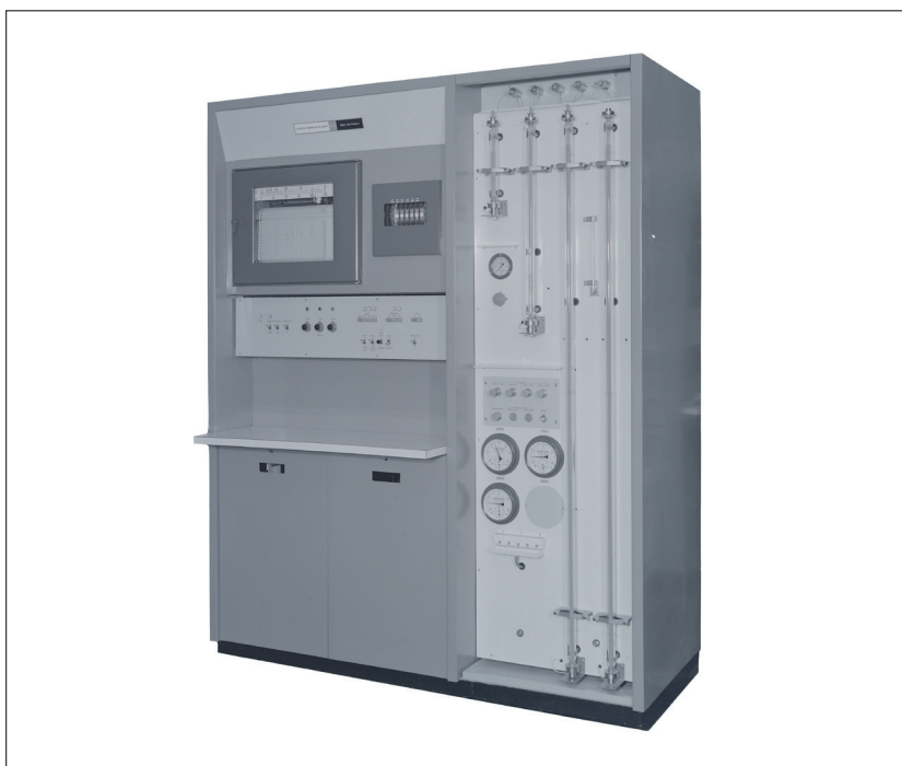
図3 KLA-3形日立アミノ酸分析計 旧ソビエト連邦、米国、中国などに輸出された。
