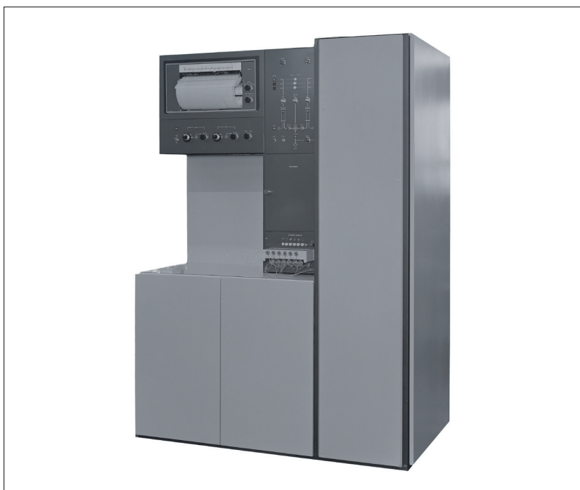
図4 KLA-5形日立アミノ酸分析計 背の高い床置き型の最終版。
