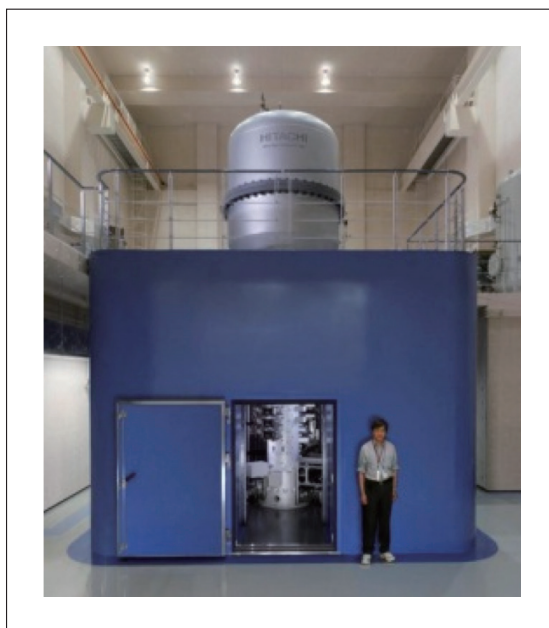
図1 1.2 MVの高加速電圧で収差補正器を搭載した超高分解能高安定ホログラフィー電子顕微鏡 最先端研究開発支援プログラムにより、独立行政法人日本学術振興会を通じた助成により開発
