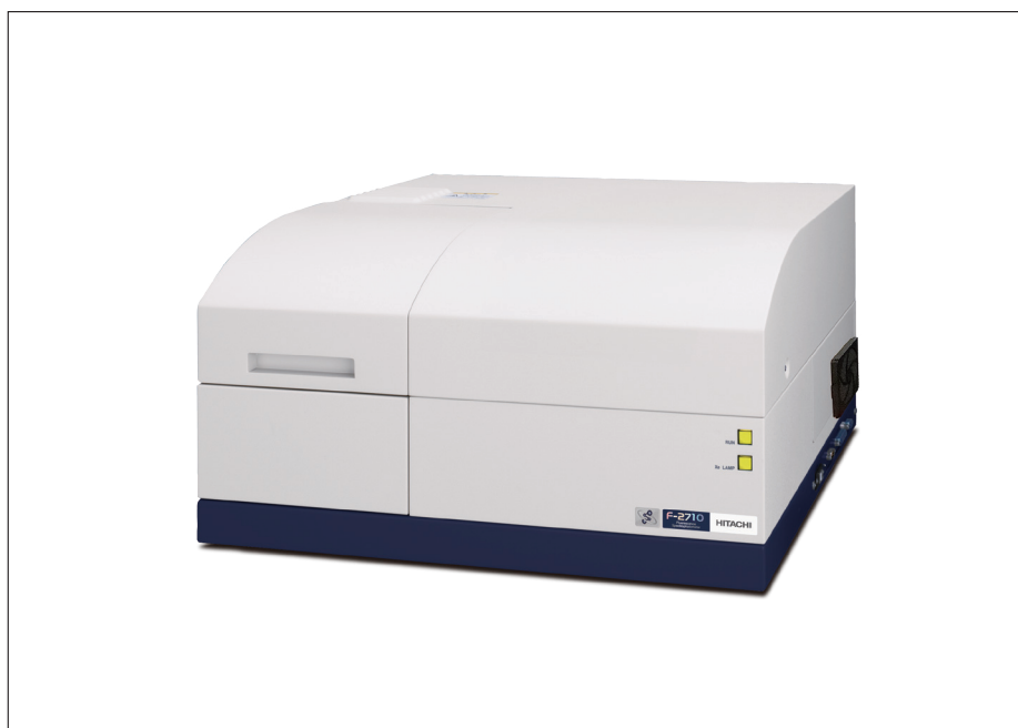
図1 F-2710分光蛍光光度計の外観
