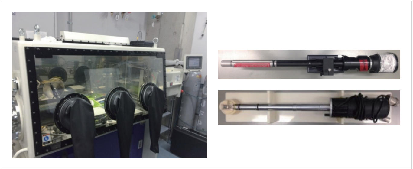
図3 硫化物系電解質を空気にさらさずにTEM観察するための実験環境 左：グローブボックス 右：真空TEMホルダー(上)と加熱用TEMホルダー(下)
