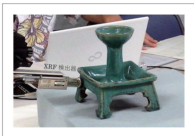
図17 国宝「緑釉四方燭台」の蛍光X線測定
