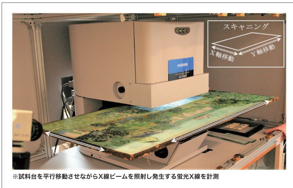
図4 ゴッホ「ドービニーの庭」のX線分析顕微鏡によるスキヤニング蛍光X線測定
