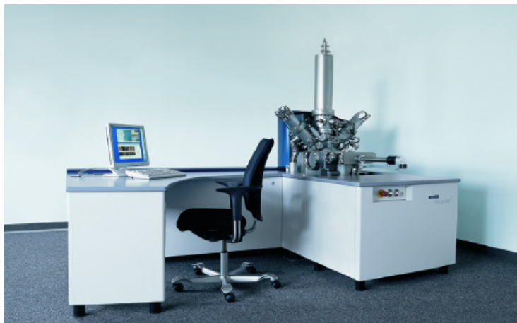
図1 TOF-SIMS装置の一例（ION-TOF社TOF.SIMS5）
