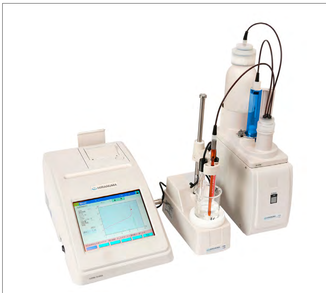
図1 平沼自動滴定装置 COM-1700A
