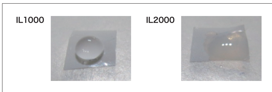
図1 IL1000とIL2000の高分子フィルムに対する親和性の比較(原液)
