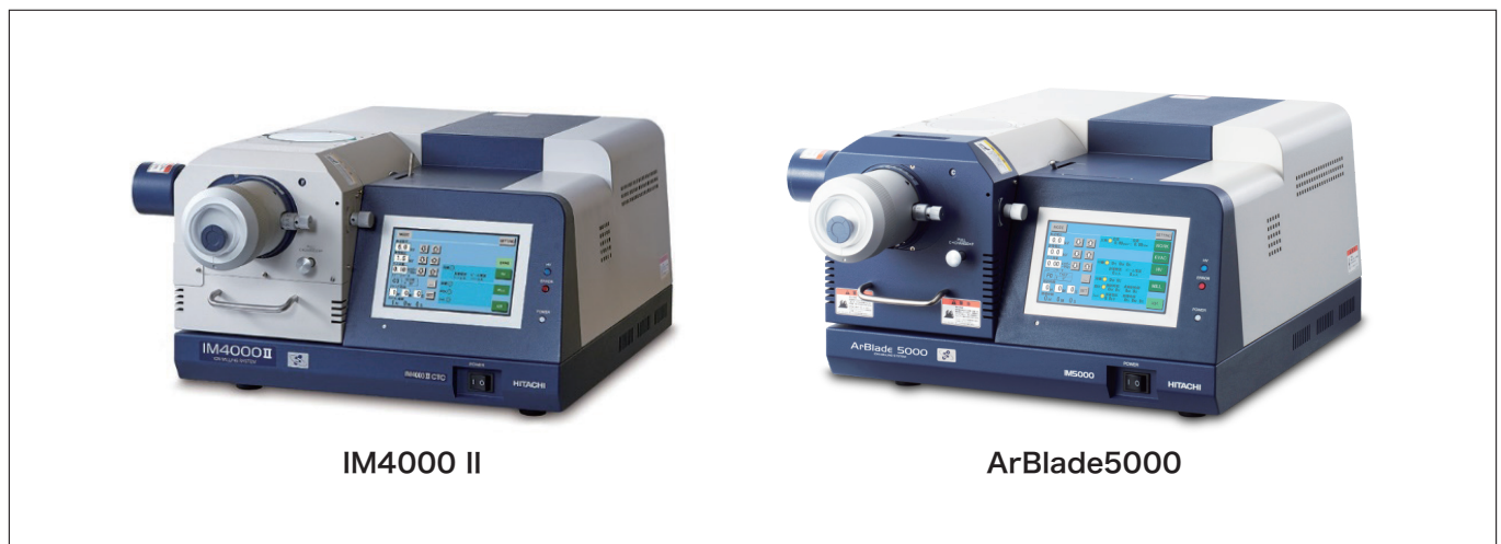
図1 イオンミリング装置IM4000 II(左), ArBlade5000(右)の装置外観図
