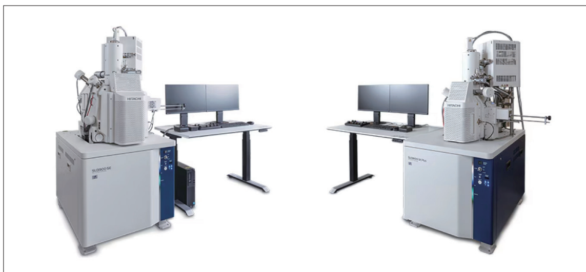
図1 日立走査電子顕微鏡SU3900SE/SU3800SE(左: SU3900SE 右: SU3800SE)
